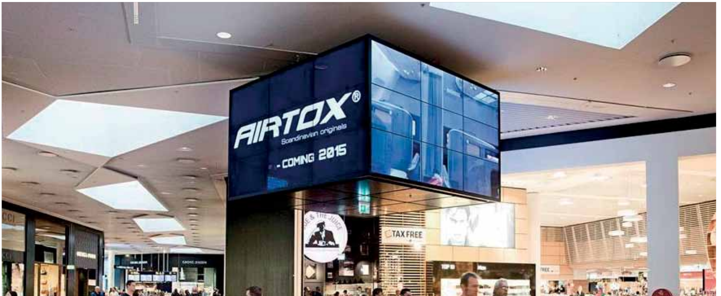
AVC fik til lufthavnens Nytorv specialproduceret en kube hvorpå skærmvægløsninger á 3x3 blev monteret på alle 4 flader.
